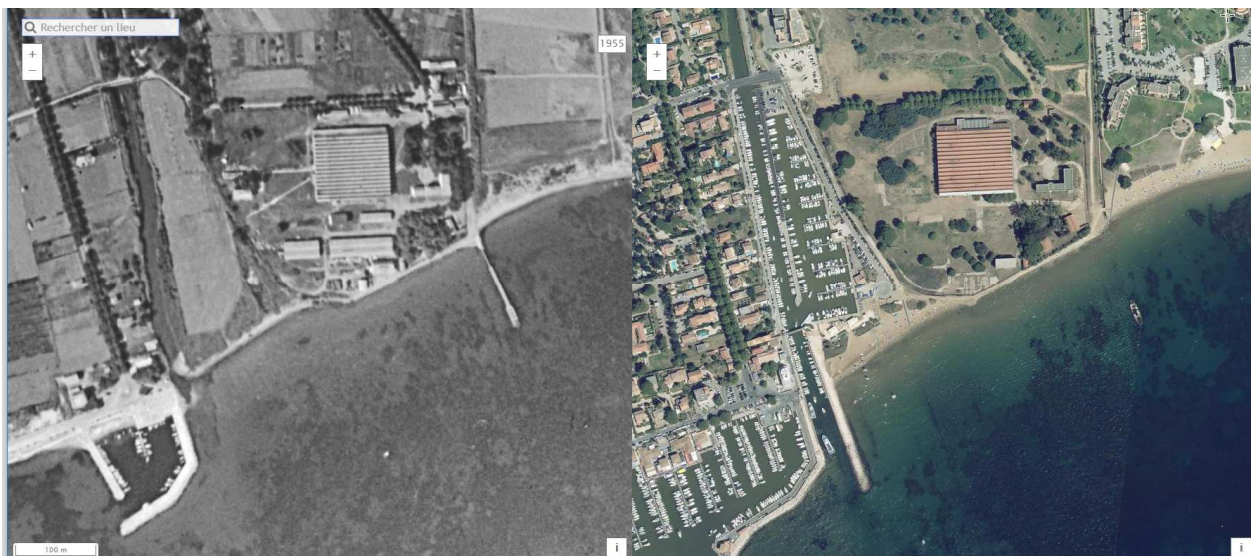
Figure 2-24 : Photographies aériennes de 1955 et actuelle (IGN, rubrique « remonter le temps ») à la même échelle, ce qui permet d'apprécier l'évolution du site (trait de côte, emprise des ouvrages portuaires...).
